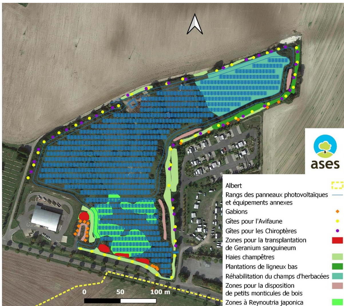
Figure 74 : Localisation des mesures ERC in situ avec le plan de calepinage des rangs de panneaux photovoltaïques.
