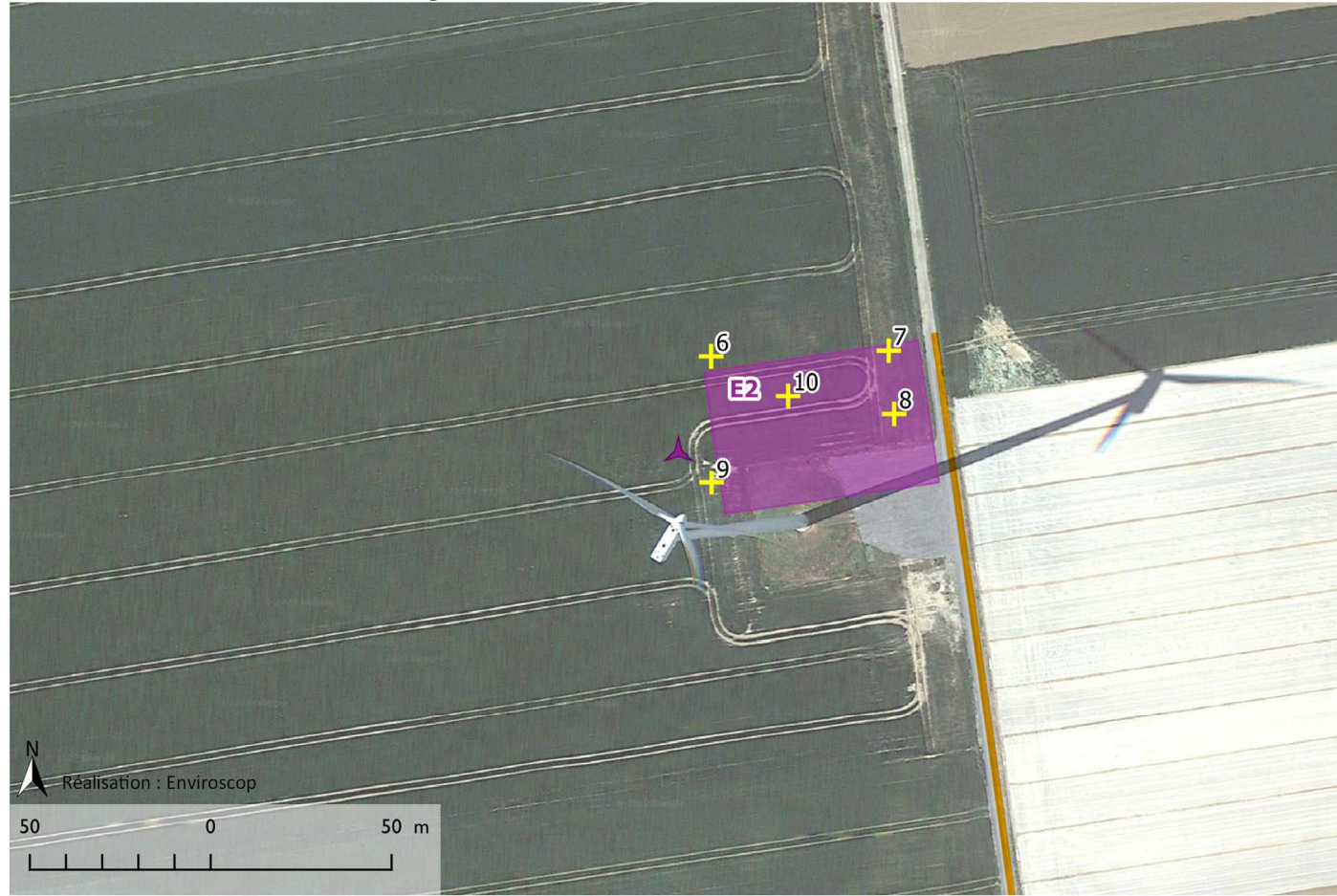
Carte 17. Localisation des sondages sur l'éolienne E2
