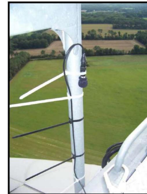
**Photo n° 10 : micro ultrasonore installé sur une éolienne.**
