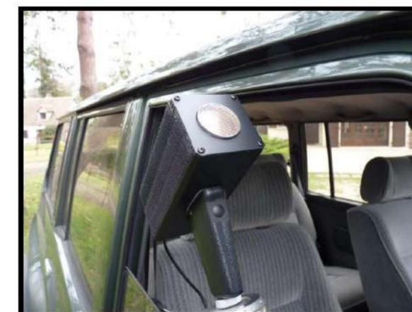
**Photo 1 : Micro ultrason fixé sur le véhicule**
