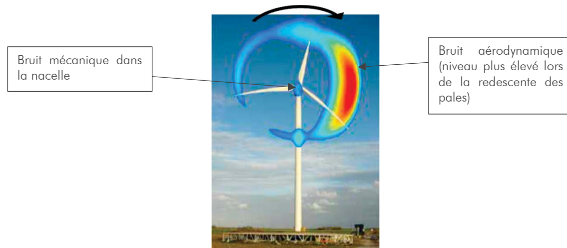
Cartographie du bruit sur une éolienne (bruit moyen sur un cycle de rotation)
