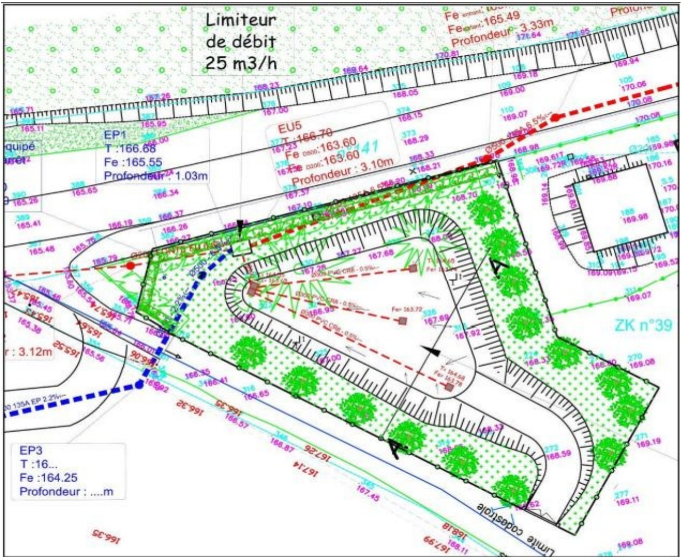
Plan masse du bassin n°1 de stockage
